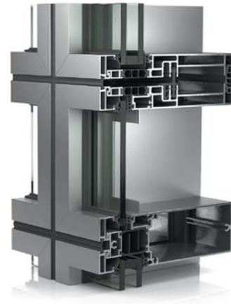
WICTEC EL60 ist die filigrane Version der Elementfassade mit besonders schlanken Ansichtsbreiten von nur 60 mm innen und außen. Die besonders elegante Optik mit „Bilderrahmeneffekt“ wird durch die von außen aufgesetzten Glasleisten mit Gehrung erzielt. Durch die optimierte Wärmedämmung setzt das System mit hervorragenden  $U_{cw}$ -Werten bis zu  $0,9 \text{ W}/(\text{m}^2\text{K})$  Zeichen.
